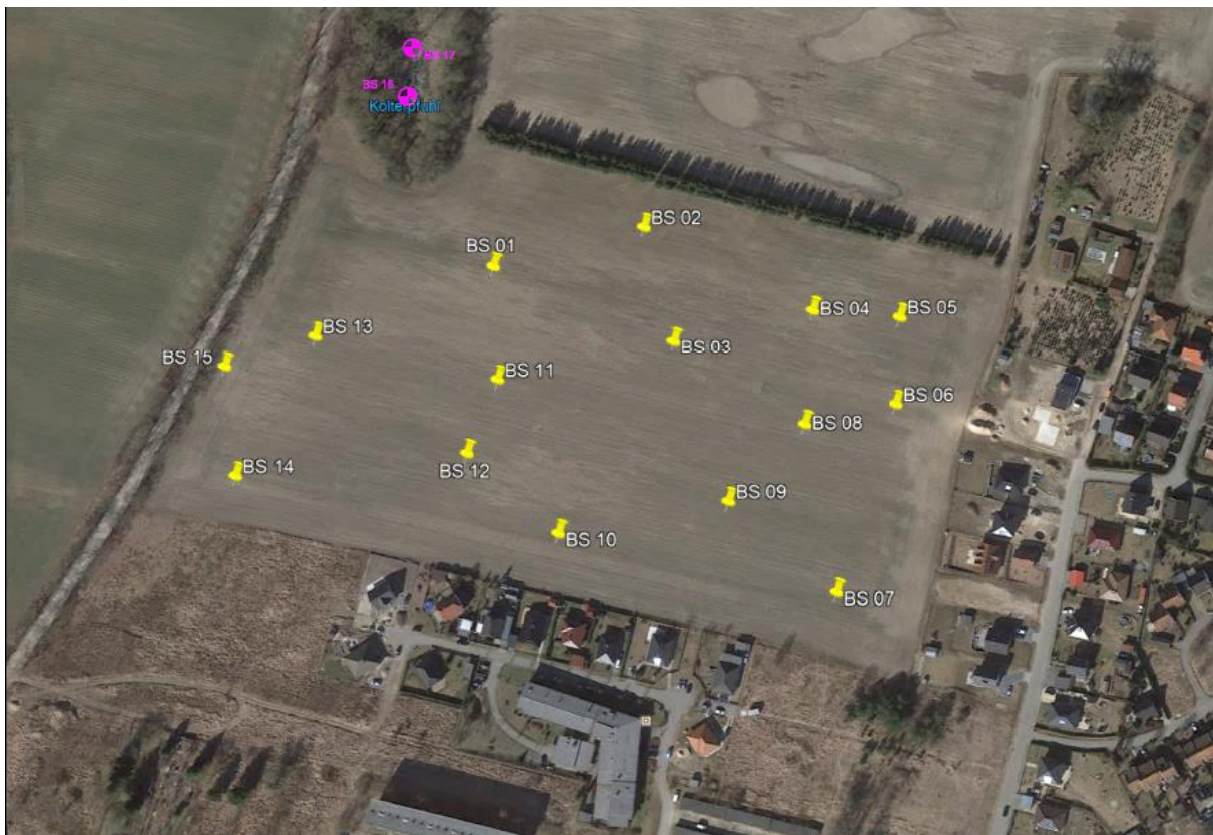
Abbildung 10: Sondierungsplan zur Baugrunderkundung (Dr. Marx, 2019)
